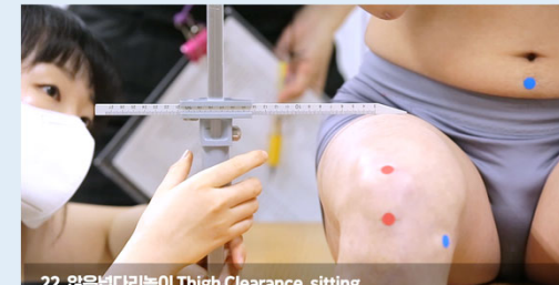
22. 앞손넙다리높이 Thigh Clearance, sitting 피측정자의 오른쪽 옆에서 수직자를 피측정자의 오른쪽 넙다리 옆 앞손백악면에 놓는다. 수직자의 가로선이 앞손넙다리위일, 즉 넙다리위로 가장 높은 수준에 닿도록 한 후 앞손백악면에서 이점까지의 수직거리를 측정한다. 넙다리 위 가장 높은 수준은 가로자를 앞뒤로 움직여서 맞춘다.
